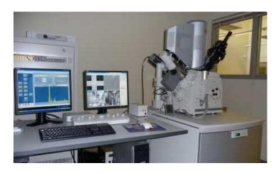
FEI Quanta 3D FEG 是一个双光束系统,配备了多种分析和操作工具,因此可以在同一腔室内应用不同的技术和方法。该系统具有高真空、低真空和 ESEM 三种成像模式。该系统包含离子柱(镓离子源)和场发射扫描电子柱。离子柱能够将高能离子(通常为 30 kV 镓离子)聚焦到极小的光斑尺寸,这与离子束的光栅运动相结合,可以通过离子溅射相互作用控制材料的去除。此外,FIB-SEM 仪器配备了许多高分辨率成像和表面分析方法,例如低真空背散射电子成像(BSE),二次电子(SE)成像以及离子诱导二次成像(ISE)和能量色散 X 射线探测器(EDS)。离子束和电子束可与气体注入系统结合使用。为了保护勘探地点,可以用两个梁中的任何一个沉积薄层的铂。该仪器还配备了帕尔贴冷却台和Omniprobe的自动化、原位和多用途纳米操纵器。
