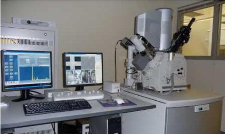
FEI Quanta 3D FEG 是一个双光束系统，配备了多种分析和操作工具，因此可以在同一腔室内应用不同的技术和方法。该系统具有高真空、低真空和 ESEM 三种成像模式。该系统包含离子柱（镱离子源）和场发射扫描电子柱。离子柱能够将高能离子（通常为 30 kV 镱离子）聚焦到极小的光斑尺寸，这与离子束的光栅运动相结合，可以通过离子溅射相互作用控制材料的去除。此外，FIB-SEM 仪器配备了许多高分辨率成像和表面分析方法，例如低真空背散射电子成像（BSE），二次电子（SE）成像以及离子诱导二次成像（ISE）和能量色散 X 射线探测器（EDS）。离子束和电子束可与气体注入系统结合使用。为了保护勘探地点，可以用两个梁中的任何一个沉积薄层的铂。该仪器还配备了帕尔贴冷却台和 Omniprobe 的自动化、原位和多用途纳米操纵器。
